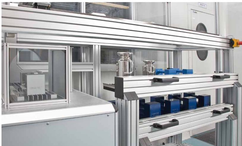
Comparateur grande capacité (AX32004-M10) de METTLER TOLEDO, pour une détermination automatisée de la masse des poids à poignées et à bouton de 1 à 20 kg.
